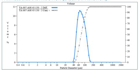
**d10**: 50 μm-55 μm • **d50**: 75 μm-85 μm • **d90**: 113 μm-120 μm
