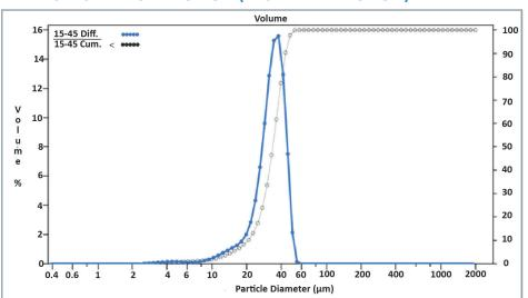
**d10**: 20 μm-25 μm • **d50**: 32 μm-35 μm • **d90**: 42 μm-45 μm
