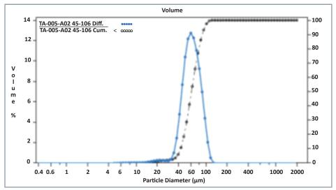
d90: 82 μm-84 μm ι ı **d10**: 38 μm-43 μm **d50**: 54 μm-61 μm
