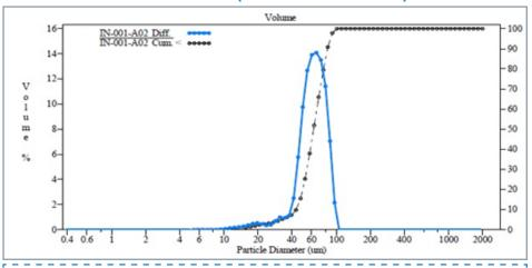
**d10:** 42 μm-46 μm • **d50:** 60 μm-65 μm • **d90:** 85 μm-90 μm
